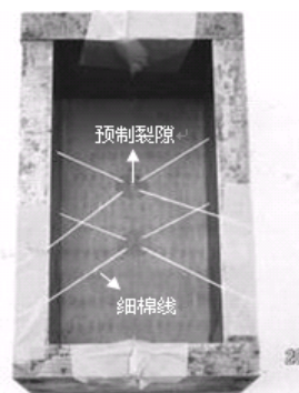
图 1 模具（用棉线定位内部裂隙） Fig.1 Die with cracks fixed by cotton string
